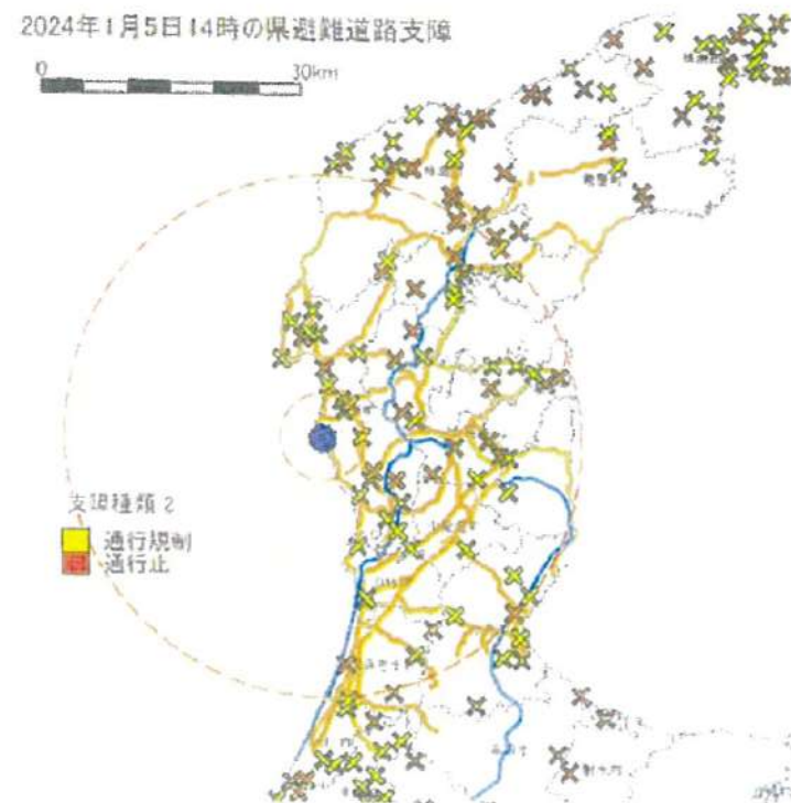
図 7 避難経路上の道路支障箇所
