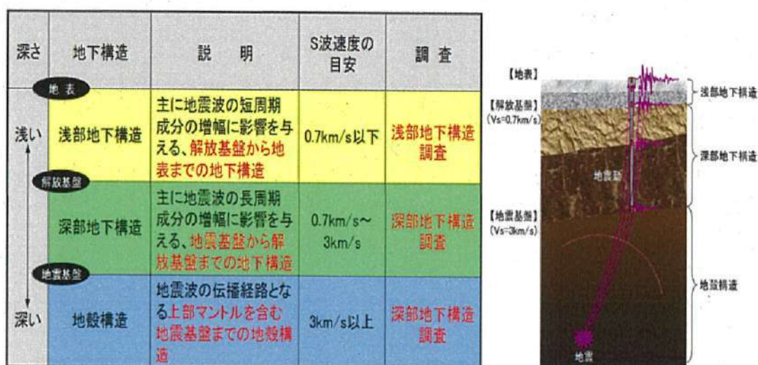
図1 地震動評価のための地下構造の定義及び概念図
